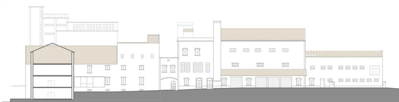
**Fig. 3.80** Corte Longitudinal pelo pátio interior, 1:750, Fábrica dos Leões. *Inês Lobo Arquitectos*
